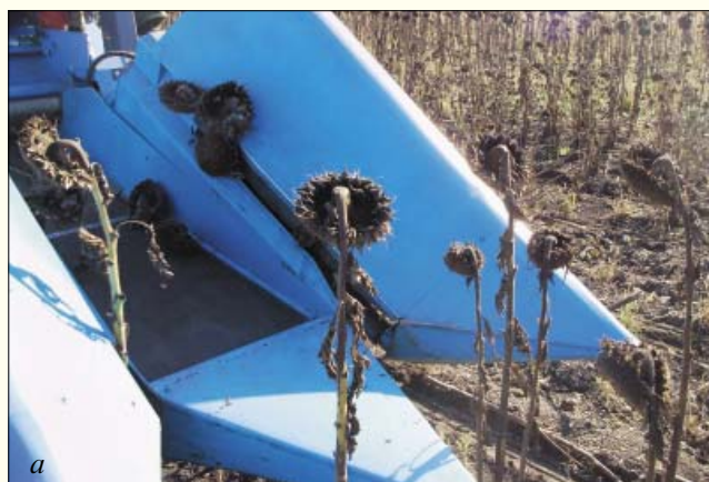
Рис. 5. Конвейер ленточный со срезанными корзинками подсолнечника: а – однокорзиночная форма; б – ветвистая многокорзиночная форма
