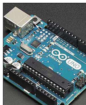
Рис. 3. Плата Arduino Uno
