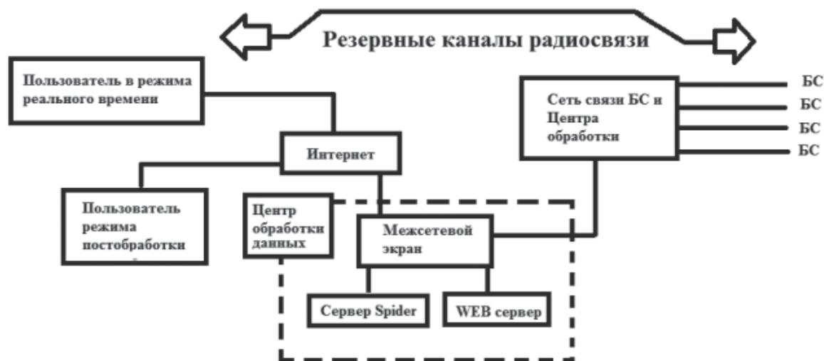
Рис. 11. Общий принцип работы базовых станций
