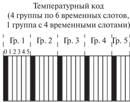
Рисунок 5. Расположение импульсов в отклике радиометки на ПАВ, формирующих температурный код в виде кода Баркера {1, 1, 1, -1, 1} (закрашенные области)
