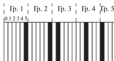
Рисунок 7. Расположение импульсов в отклике радиометки на ПАВ, формирующих температурный код в виде кода Баркера {1, 1, 1, -1, 1} (закрашенные области)
