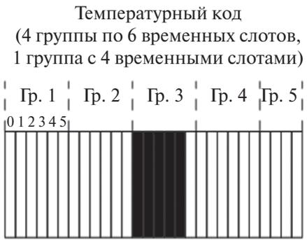
Рисунок 3. Расположение импульсов в отклике радиометки на ПАВ, формирующих температурный код в виде кода Баркера {1, 1, 1, -1, 1} (закрашенные области)
