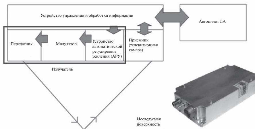
Рисунок 1. Концепция оптико-электронной системы автоматической посадки БВК
