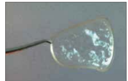
Рис. 5. Пленчатый матрикс из рекомбинантного белка спидроина для создания искусственной роговицы.
