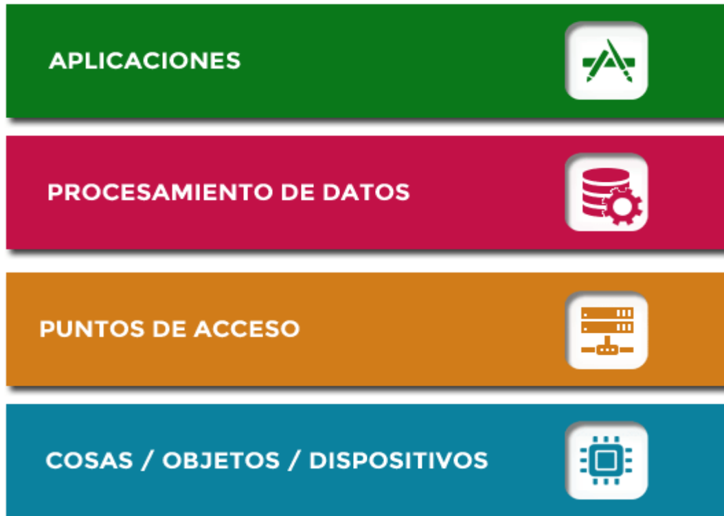
Figura 4 Proceso por el cual la información fluye del medio físico a un medio virtual (Hernández, 2018)
