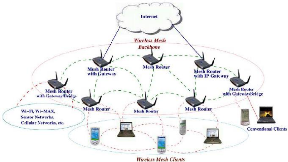
Figura 64. Funcionamiento de una Red Mesh http://www.qta.ufri.br/grad/06_2/felipe/arquitetura_ff.htm
