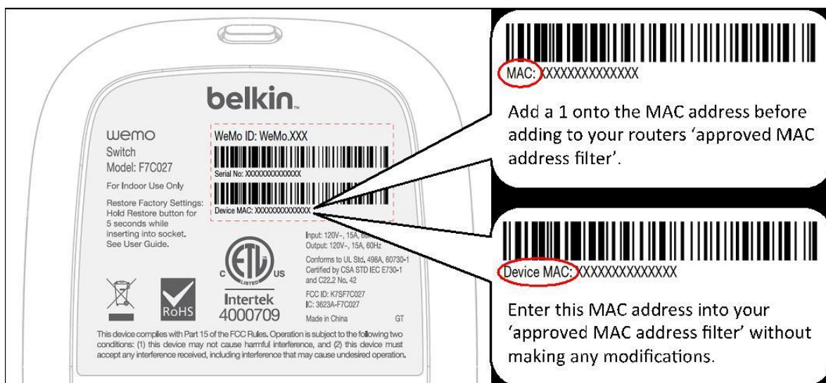
Figura 24. Ejemplo de una dirección MAC 2001 http://www.seguridad.unam.mx/noticia/?noti=672
