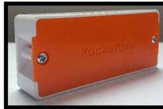
Figura 4. Sensores inerciales PocketLab, Myriad Sensors (Tamaño de 7,5 cm x 3,8cm x 1,6 cm)
