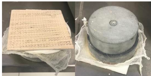
Figura 3.13 - Ensaio de retenção de água.
