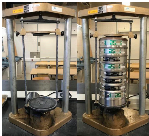
Figura 3.6 - Peneiração do agregado.
