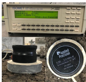
Figura 3.14 - Equipamento ISOMET 2104 utilizado no ensaio de condutibilidade térmica.
