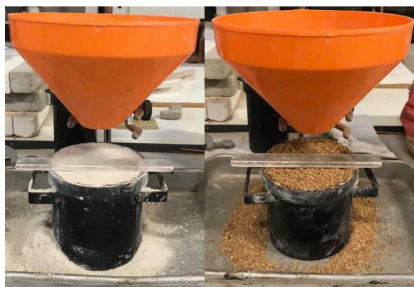
Figura 3.10 - Ensaio da baridade.
