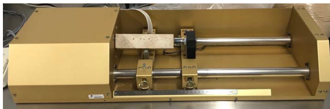
Figura 3.15 - Equipamento ZEUS Resonance Meter.
