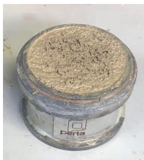
Figura 3.12 - Ensaio da massa volúmica aparente no estado fresco.
