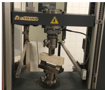
Figura 3.16 - Ensaio de resistência à tração por flexão.
