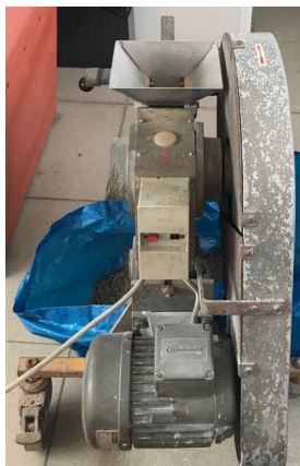
Figura 3.3 - Máquina de moagem Retsch.
