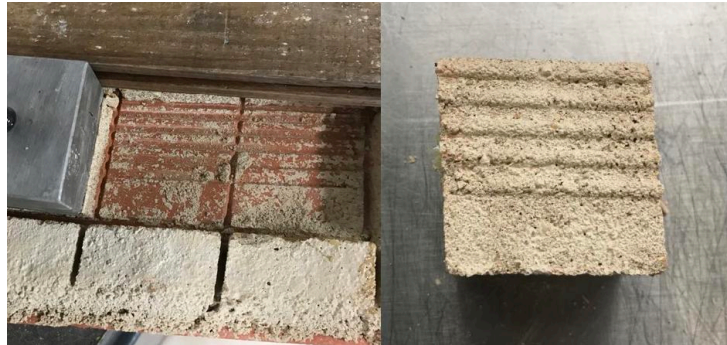
Figura 4.19 - Resultado do ensaio de aderência ao suporte na argamassa (Ref.).
