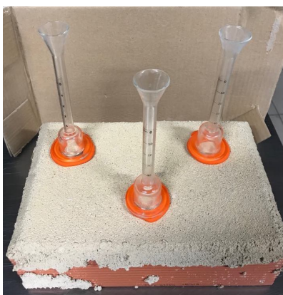
Figura 3.22 - Tubos de Karsten aplicados nos provetes de monocamada.
