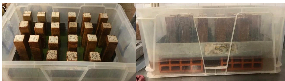
Figura 3.20 - Ensaio de absorção de capilaridade.
