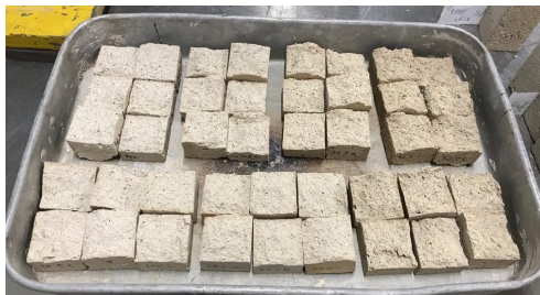
Figura 3.18 - Amostras utilizadas no ensaio de massa volúmica aparente e porosidade aberta.
