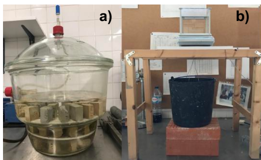
Figura 3.19 - Ensaio de determinação de massa volúmica aparente e porosidade aberta: (a) exsiccador; (b) aparato da pesagem hidrostática.
