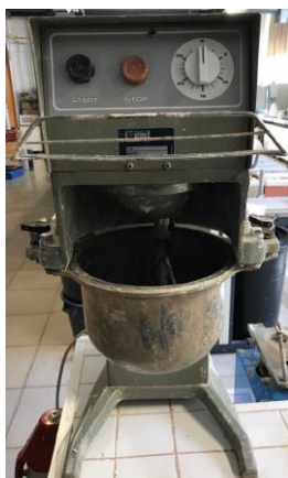
Figura 3.11 - Misturador mecânico do laboratório.
