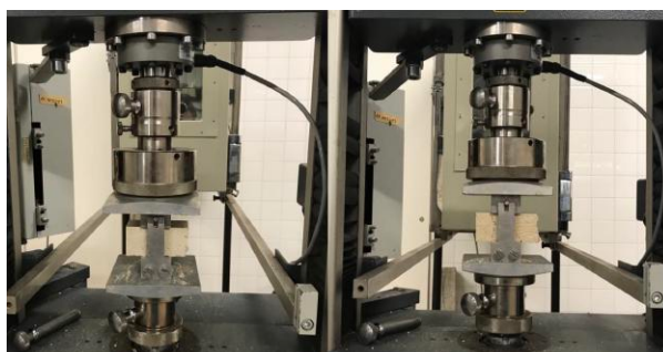
Figura 3.17 - Ensaio de resistência à compressão.
