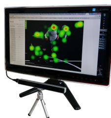
Figura 2.4: Exemplo de um modelo *eye-tracker* não intrusivo
