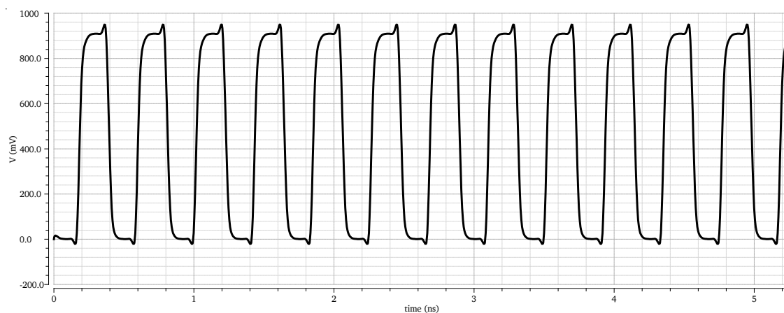
Figura 4.37: Sinal de saída do oscilador em anel com sete inversores CMOS.
