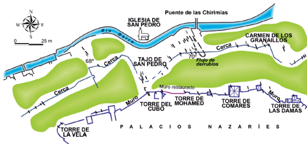
Figura 2. Esquema del recinto de la Alhambra y las zonas próximas, en la que se han representado las principales fallas. Obsérvese el meandro que forma el río Darro a la altura del Tajo de San Pedro.
