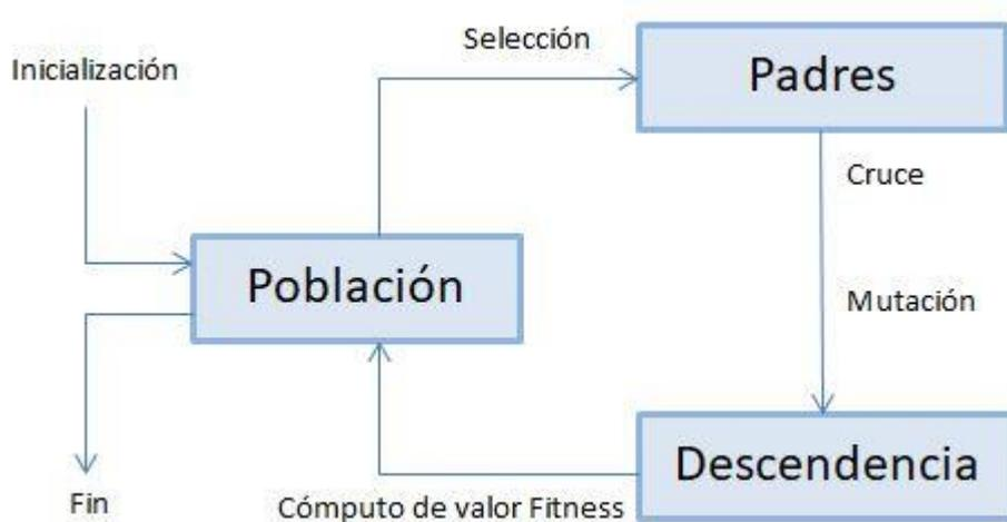
Figura 2-2. Esquema de resolución de un problema mediante el uso de Algoritmo Evolutivo Simple.
