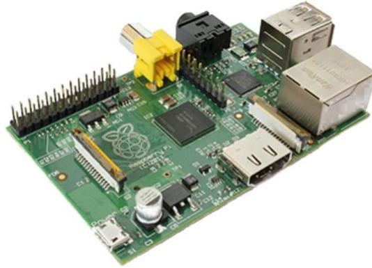
Figura 3-2. Raspberry de primera generación. Modelo B.
