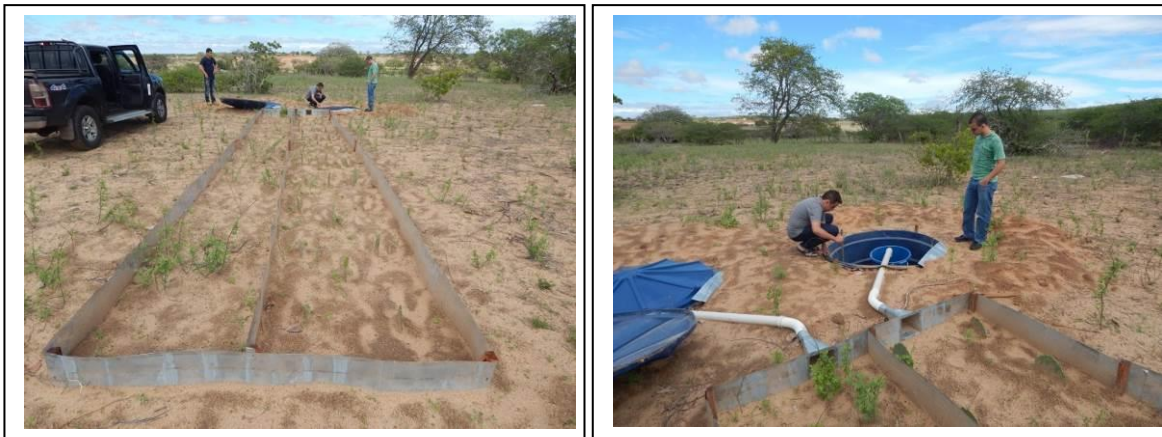
Figura 2. Parcelas hidro-erosivas instaladas na zona rural do município de Juazeirinho-PB.
