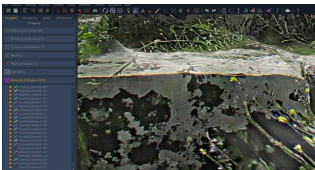
Figura 6 – Zephyr: tracciamento della polilinea sul modello 3D
