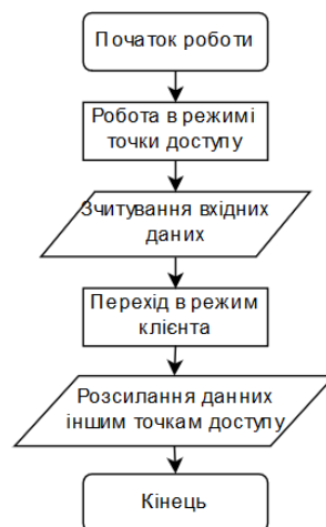
Рис. 8. Загальний алгоритм роботи Mesh-мережі на МК
