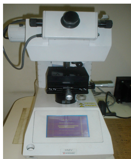
Figura 4. Microdurómetro (SHIMADZU, Kyoto, Japan) Modelo HMV-2.
