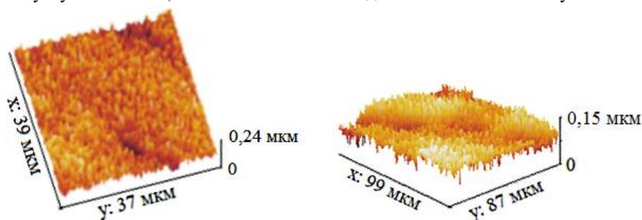
Рис. 3. 3D — визуализация поверхности сервоитной пленки
