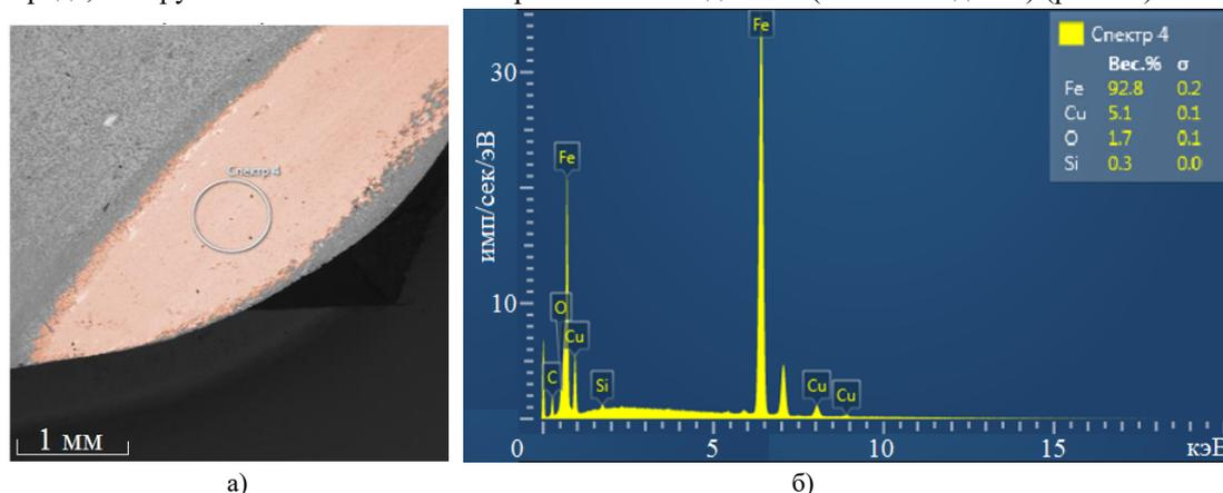
Рис. 2. Результаты сканирующей электронной микроскопии поверхности сервовитной пленки, полученной при трении пары бронза-сталь в водном растворе гликолевой кислоты: а — изображение сервовитной пленки на поверхности стального образца; б — EDS-спектр
