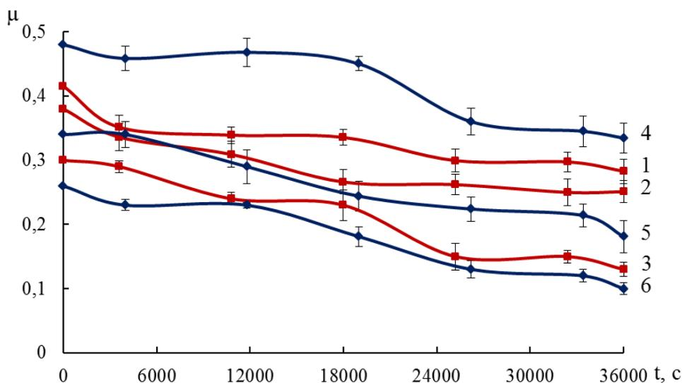
Рис. 1. Эволюция коэффициента трения ( $\mu$ ) от времени ( $t$ ) в системе «бронза-водный раствор кислоты-сталь» с молярной концентрацией кислот: 1-3—0,1 моль/л; 4-6—0,2 моль/л: 1, 4—щавелевая кислота; 2, 5—уксусная кислота; 3, 6 — гликолевая кислота
