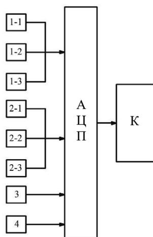
Рис.3. Блок-схема КИК: 1-1; 1-2; 1-3 — датчики измерения фазового напряжения электрического тока на входе индуктора  $U_\phi$  в В; 2-1; 2-2; 2-3 — датчики измерения фазовой силы электрического тока на входе индуктора  $I_\phi$  в А; 3 — датчик измерения частоты колебания электрического тока  $f$  в Гц; 4 — датчик измерения магнитной индукции  $B_m$  в мТл; АЦП — аналого-цифровой преобразователь; К — компьютер
