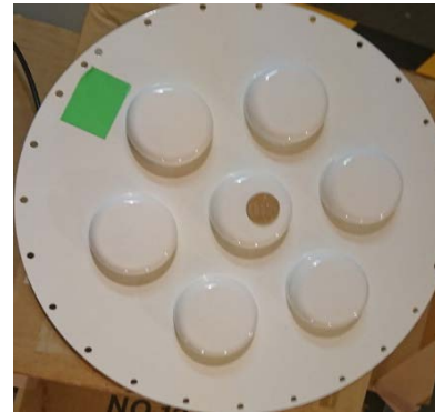
Fig. 17. Seven-element array antenna
