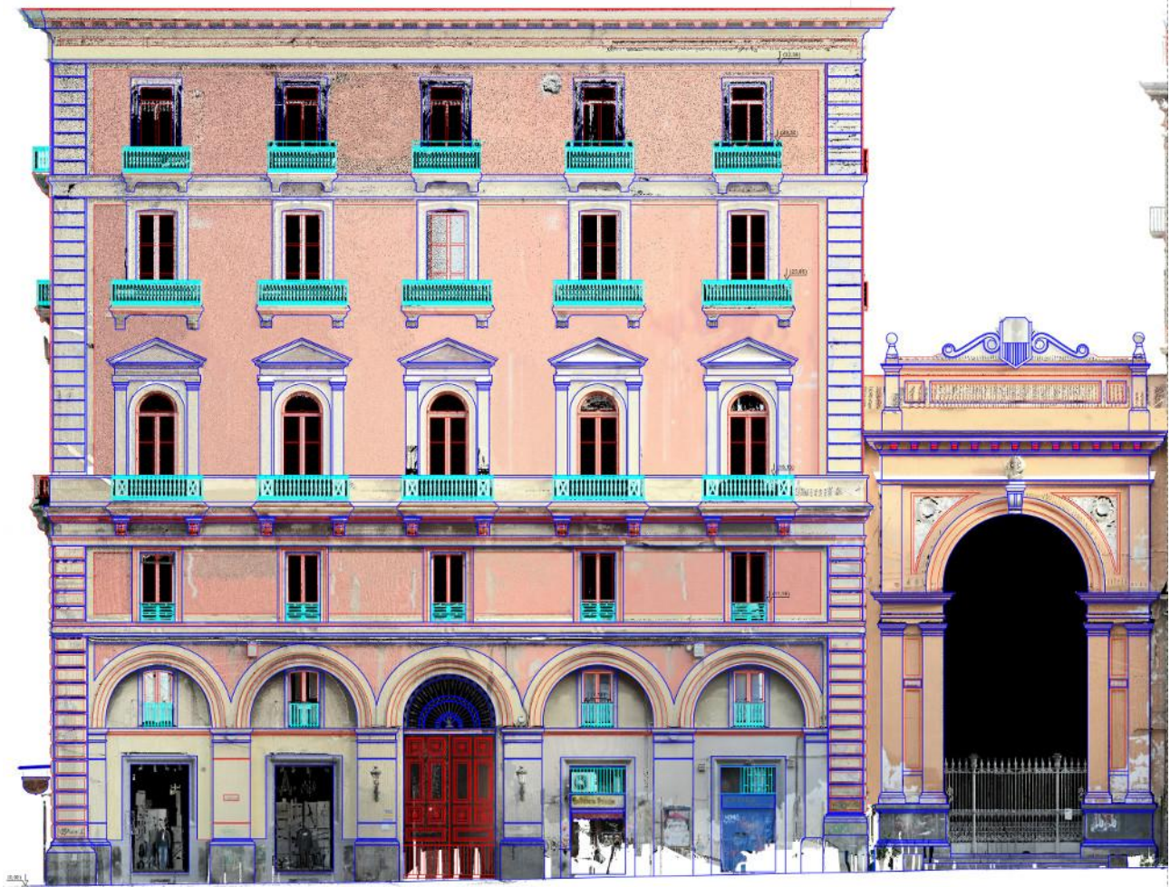
Figura 4: Rilievo laser-scanner di un edificio ottocentesco. Fonte: Sgobbo, 2015
