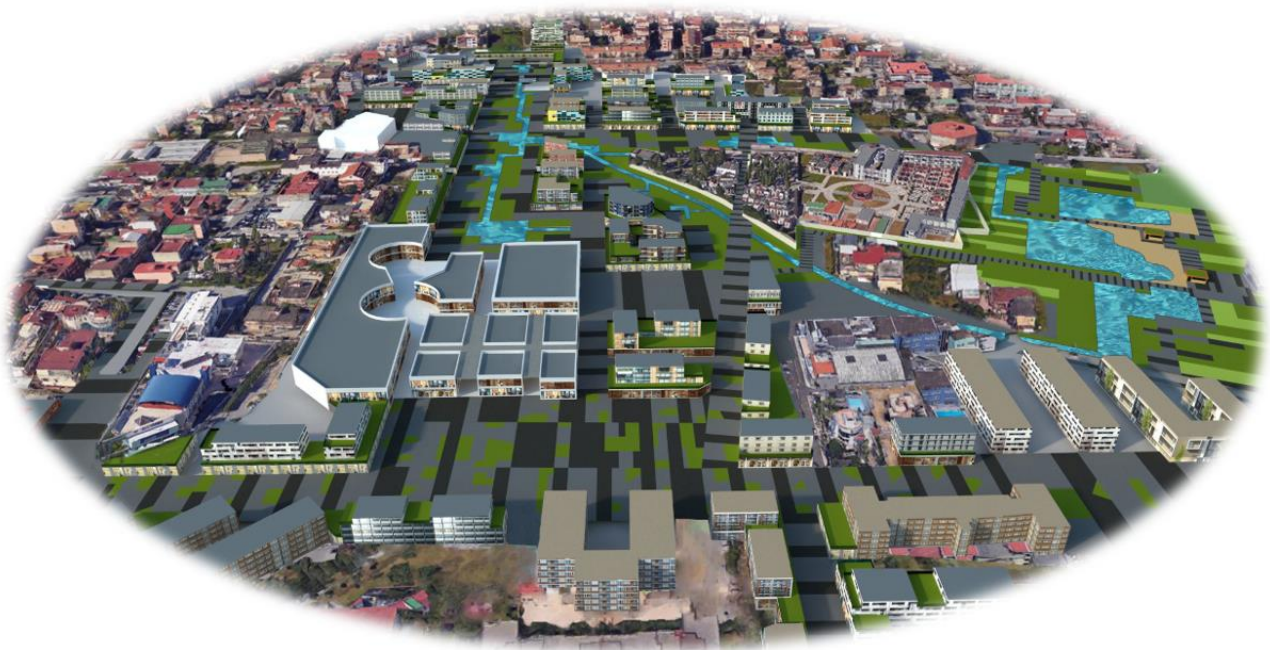
Figura 2: L'approccio WSUD utilizzato in un caso studio di rigenerazione urbana: rete di smaltimento superficiale in condizioni ordinarie di funzionamento. Fonte: Carbone, Corrado, De Nicola e Faiella, 2017.
