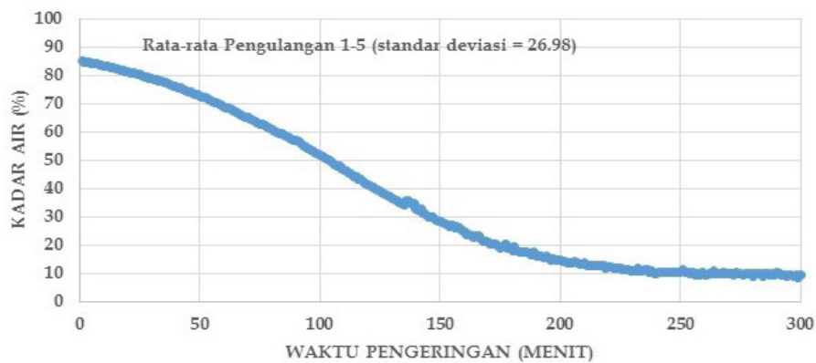
Gambar 3. Grafik hubungan kadar air kunyit dengan waktu pengeringan
