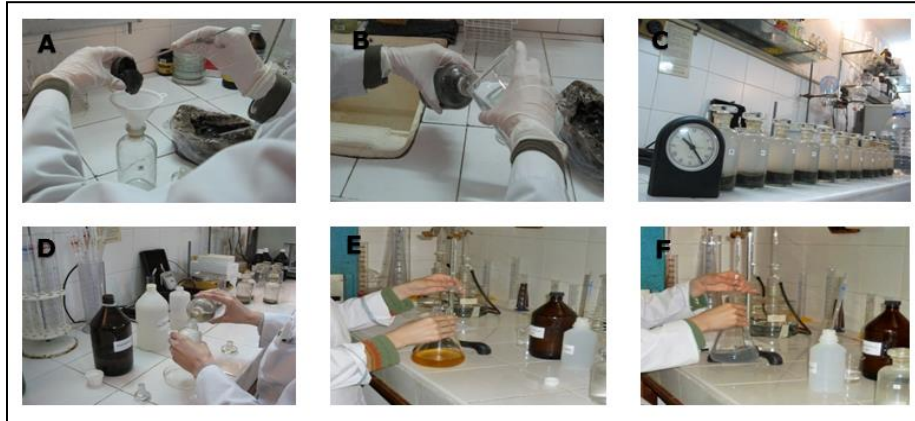
Figura 2. A: siembra del sedimento; B: llenado del respirómetro con agua de dilución; C: respirómetros sembrados; D: trasvase del agua confinada al frasco de reacción; E y F: titulación del OD.
