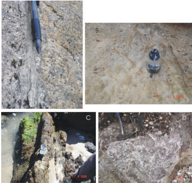
Figura 8: (A) Faixa de cisalhamento dúctil, com milonito, seccionando Granito Ilha. (B) Filito milonítico com foliação subvertical. (C) Faixa de cataclasitos e brechas de falha. (D) Brecha de diabásio de dique do Enxame Florianópolis, cimentada por sílica.
