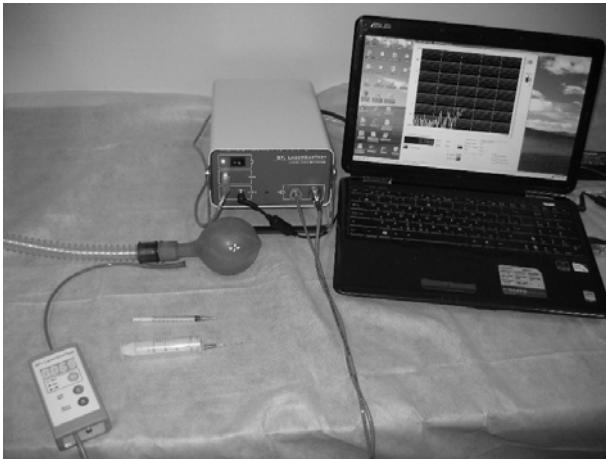
Рис. 1. Моделирование методики обнаружения местоположения и интенсивности нарушения герметичности дыхательной системы в режиме ИВЛ. ЛОАТ «LaserGasTest» и имитация дыхательной системы (резиновый шарик). Крестом на шарике отмечено место нарушения герметичности (искусственный прокол иглой 26G).
