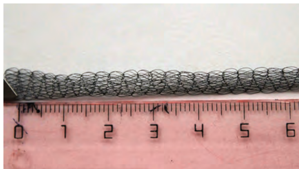
Рис. 1. Сетчатый протез из никелида титана, толщина нити 60 мкм.
