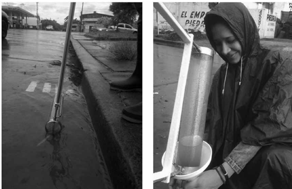
Figura 10. Recolección de muestras mediante captador DH3.
