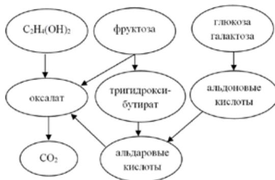
Рис. 1. Схема окисления органических темплатов в гидротермальных условиях
