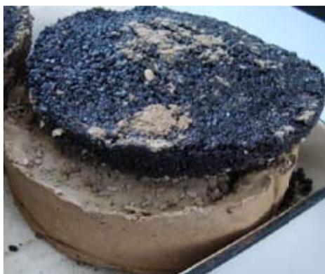
Рис. 4. Образец, содержащий криогель на основе ПВС
