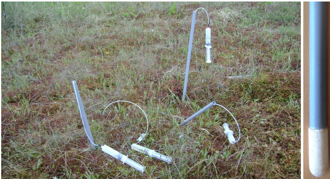
Figuur 8.39. Monitoring van de veenwaterkwaliteit op verschillende diepten met ceramische cups in het Haaksbergerveen (links). Rechts een foto van de ceramische cup. Foto's: Hilde Tomassen.
