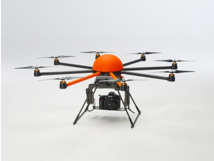
Figuur 8.33. De Height Tech HT-8 RPAS ('drone'), zoals aangeschaft door KWR. Door deze uit te rusten met een geavanceerde fotocamera en met inzet van RTK-GPS kunnen hoogtedata zeer precies worden ingewonnen.
