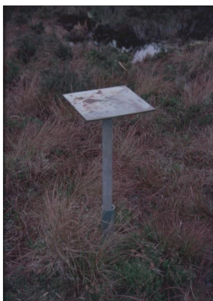
Figuur 4.15. Vast punt voor waterpassing van peilbuizen op Raheenmore Bog, tevens gebruikt voor het meten van Mooratmung (BM3 in Figuur 4.16 en Tabel 4.1) De manchet van de voetplaat om de stalen pijp is duidelijk te zien.
