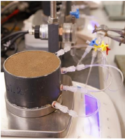
Figuur 8.40. Meetopstelling van de zogenaamde verdampingsmethode voor het bepalen van een deel van de retentie- en onverzadigde waterdoorlatendheidskarakteristiek (bron: Bakker et al. 2015).
