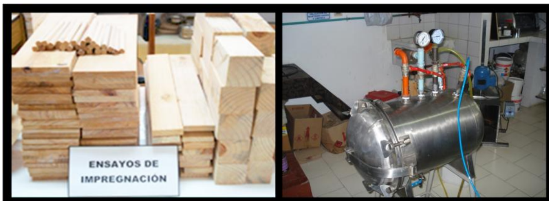
Figura 7 Dimensiones de probetas (10 x 10 x 150 mm, 10 x 50 x 200 mm, 15 x 100 x 400 mm, 50 x 50 x 150 mm, 20 x 20 x 400 mm) a impregnar con las diferentes soluciones y autoclave utilizada.
