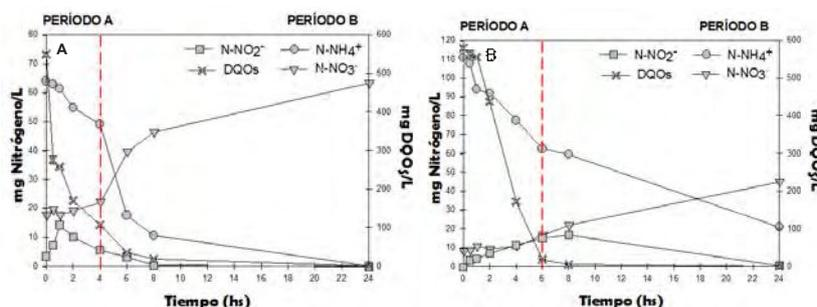
Figura 1: Perfil del  $N-NH_4^+$  (•),  $N-NO_3^-$  (▼),  $N-NO_2^-$  (■), DQOs (x) a lo largo de un ciclo de operación. A) Condición 1 B) Condición 2 (Para una mejor interpretación de resultados se exponen los resultados pertenecientes sólo a un ciclo).
