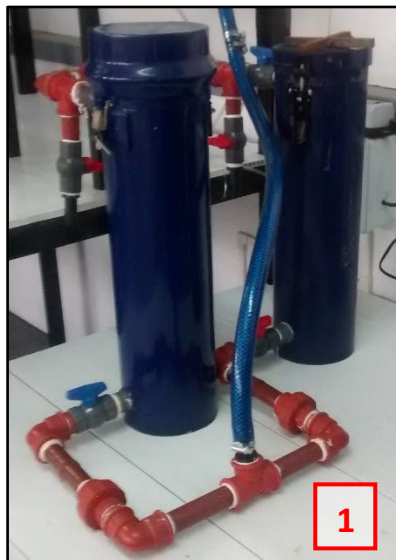
Figura 6.18. Detalle de las columnas conectadas en paralelo ( Q_d = 750 \text{ mL/min} por columna).
