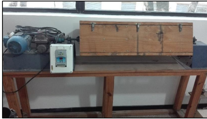
Figura 2.10. Agitador rotacional utilizado para realizar el ensayo de lixiviación TCLP.
