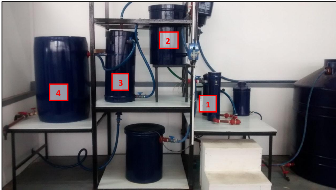
Figura 6.17. Fotografía de la planta utilizada para la realización de ensayos a escala real en instalaciones de la Facultad ( Q_d = 1500 \text{ mL/min} ).
