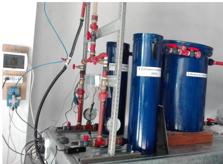
Figura 7.17. Planta para el tratamiento de 4 m 3 /día instalada en la cooperativa de Verónica.
