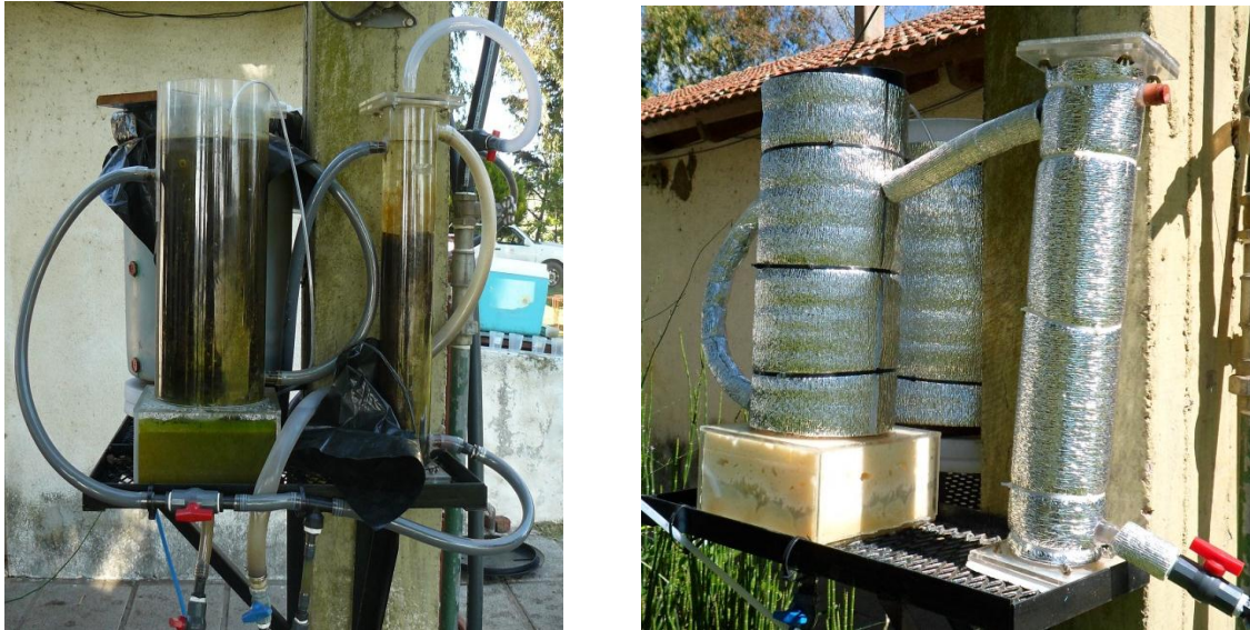
Figura 7.6. Aislación del prototipo instalado en la vivienda de los productores de Gral. Rodríguez.
