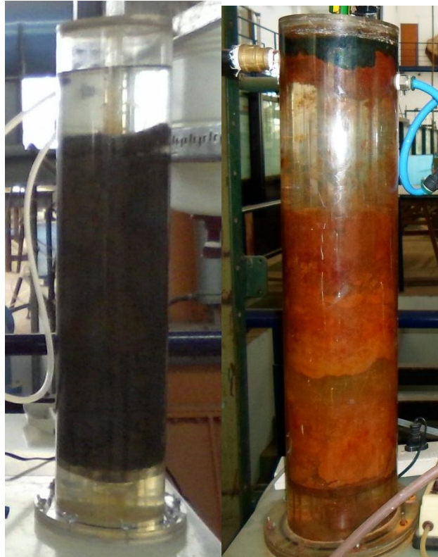
Figura 6.12. Aspecto del relleno de ZVI antes (izq.) y después del proceso de tratamiento (der.).
