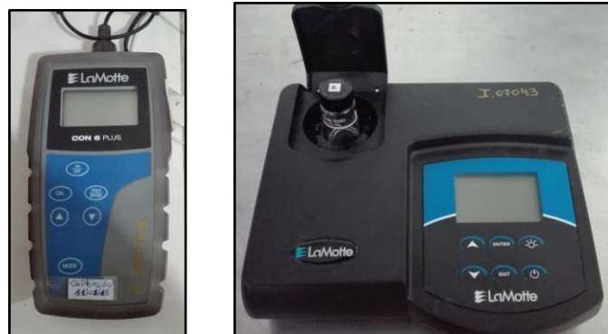
Figura 2.8. Conductímetro (izq.) y turbidímetro de mesada (der.) utilizados marca LaMotte.
