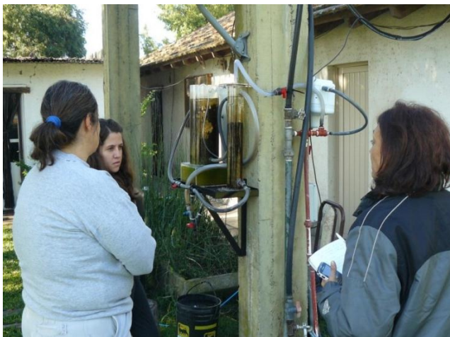
Figura 7.5. Proliferación de algas en el prototipo instalado en la vivienda de los productores de Gral. Rodríguez.
