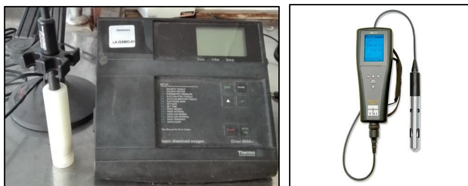
Figura 2.7. Izquierda: electrodo para la determinación de oxígeno de membrana selectiva y consola marca Thermo Orion. Derecha: sensor óptico de oxígeno YSI ProODO.
