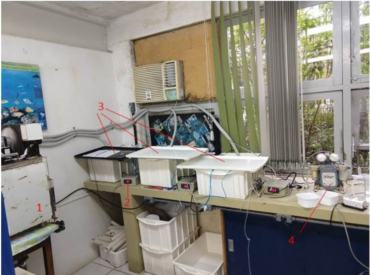
Figura 3. Estrutura do mesocosmos. 1) Resfriador; 2) Termostato; 3) Caixas em que as colônias permaneceram em banho-maria; 4) Bomba de ar para aeração.
