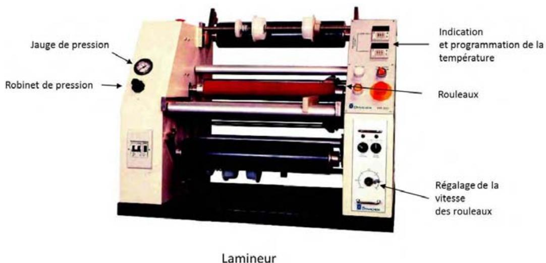
Figure IV.18 Image du lamineur utilisé dans la salle blanche du LAAS.
