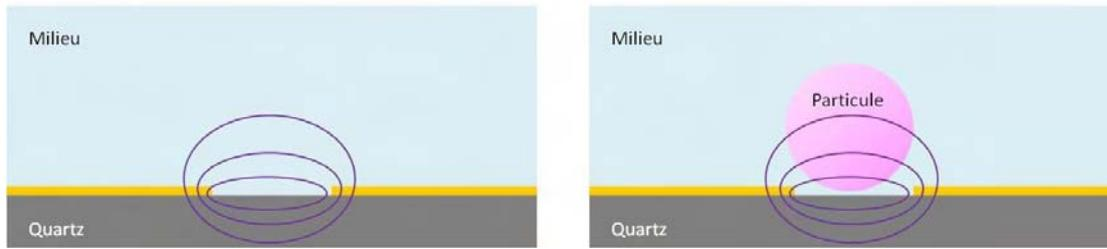
Figure III.27. Schéma du dispositif sans (gauche) et avec (droite) particule piégée.
