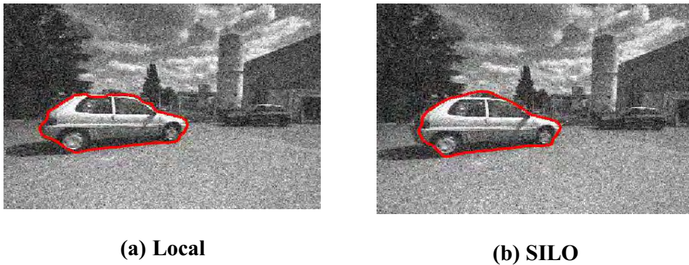
Fig. 5.8 - Segmentation de la voiture utilisant les approches locale et SILO basées sur une initialisation adéquate du CA
