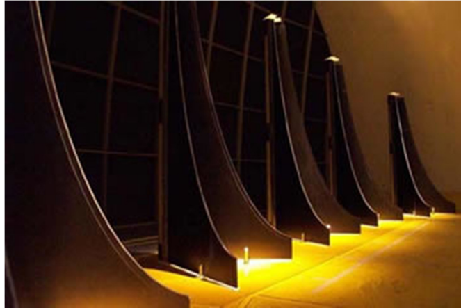
Figure 28 - Pininfarina TGS vanes - Cogotti et al (2007)
