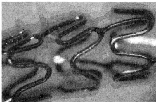
2. ábra A kémiai maratással gyártott IVT Stent
