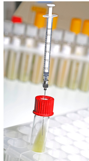
Abbildung 3.1: Probennahme bakterieller VOCs mittels NTME. Entnommen aus Publikation 2.
