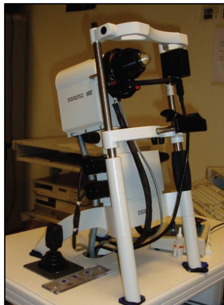
ABBILDUNG 9: UNTERSUCHUNGSVORRICHTUNG ROSTOCKER LASER-SCANNING-MIKROSKOP (RLSM) [155]
