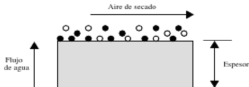
Figura 1. Mecanismo de difusión superficial y transporte de vapor de agua Fuente: (Ibarz y Barbosa, 2008)
