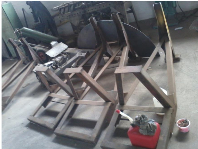
Bases de Concretera
