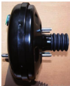
Figura 2.7. Servofreno o servo asistencia (Borja , Fenoll, & Seco de Herrera , Sistema de transmisión y frenado, 2009, pág. 198)
