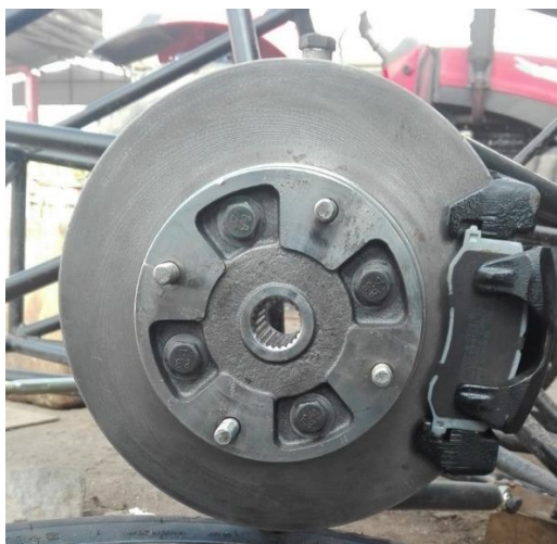
Figura 3.29. Disco de freno instalado calipers y pastillas
