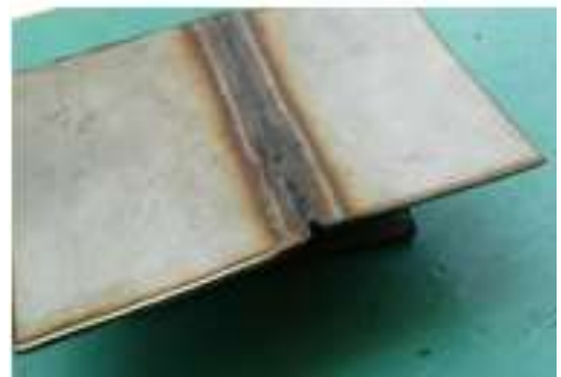
4.12. Inspección visual de la penetración.
