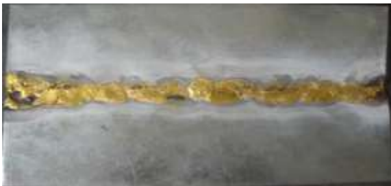
Figura 4.15. Cordón de soldadura plana oxiacetilénica.
