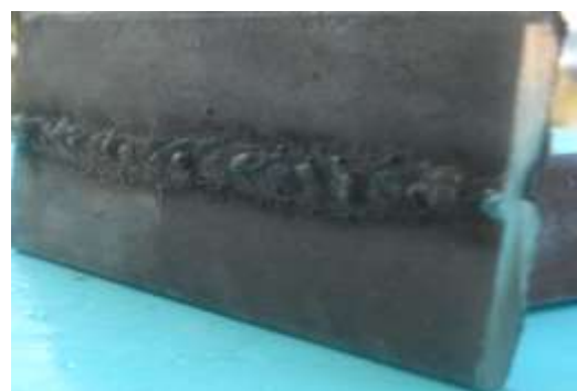
Figura 4.6. Inspección visual de la penetración.
