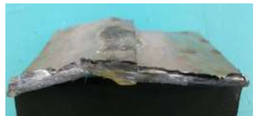
Figura 4.18. Inspección visual de la penetración.
