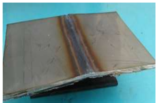
Figura 4.10. Inspección visual de la penetración.
