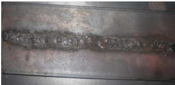
Figura 4.1. Cordón soldadura plana a tope SMAW.
