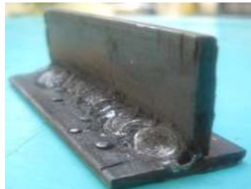
Figura 4.4. Inspección visual de la penetración.
