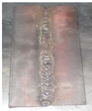
Figura 4.5. Cordón de soldadura vertical SMAW.
