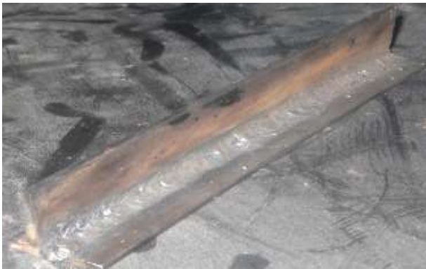
Figura 4.3. Cordón de soldadura en ángulo SMAW.
