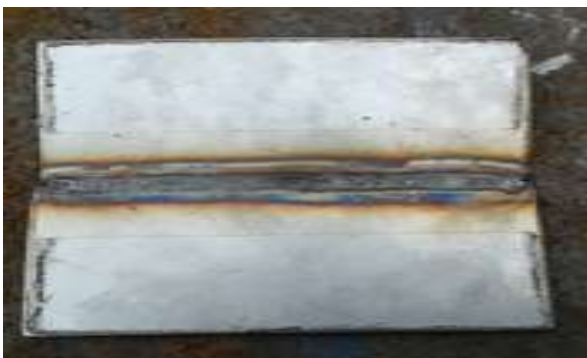
Figura 4.9. Cordón de soldadura plana TIG.
