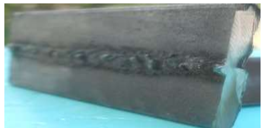
Figura 4.8. Inspección visual de la penetración.
