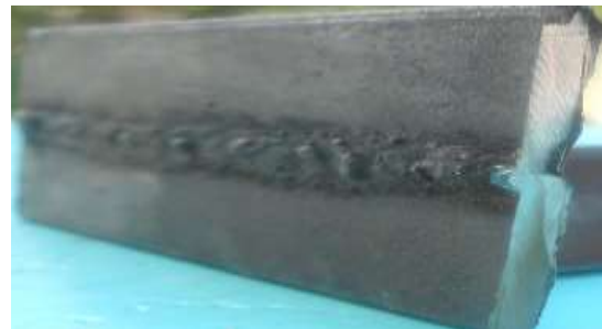
Figura 4.2. Inspección visual de la penetración.
