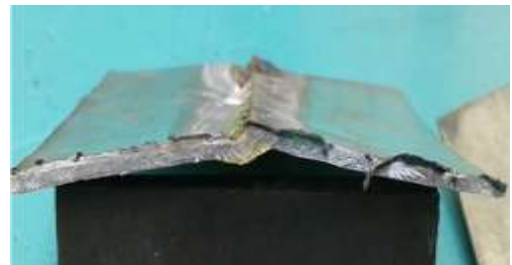
Figura 4.16. Inspección visual de la penetración.
