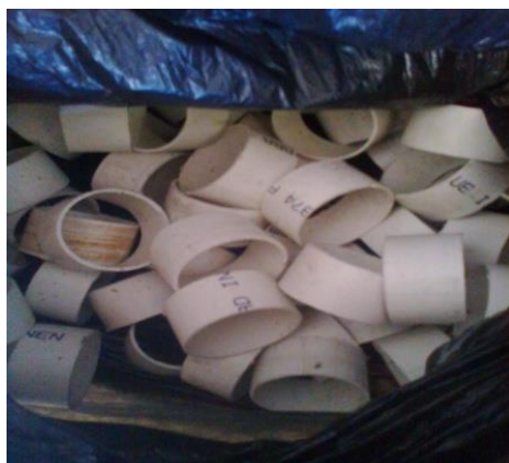
Figura 3. 21. Aros de tubo PVC de 2"de diámetro por 4 cm de alto
