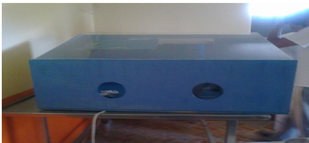
Figura 3. 29. Cámara de inoculación
