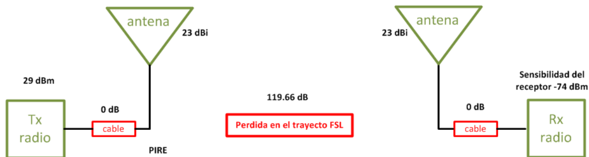
Figura 73: Esquema general del cálculo del presupuesto de potencia del enlace entre estación base y estación cliente Juna de Dios Navas
