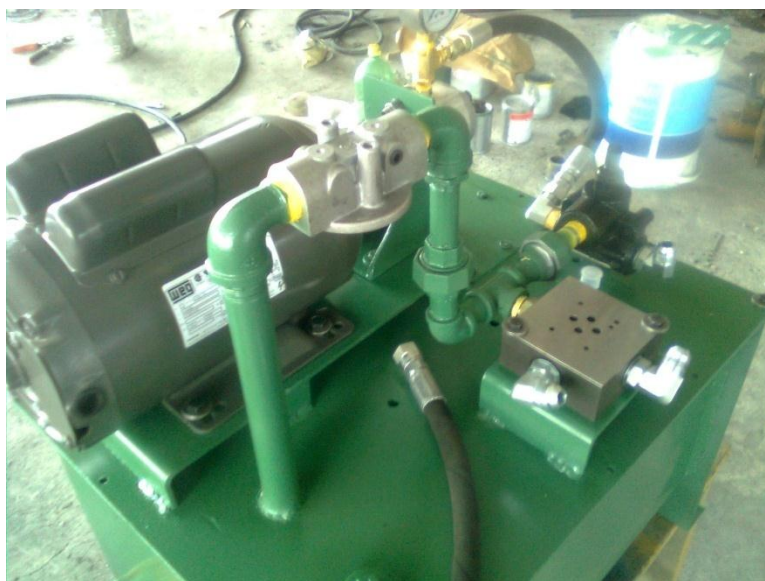
Figura 4.2 Construcción Unidad de potencia hidráulica
