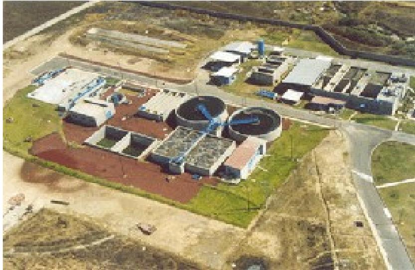
Ilustración 23: Planta de Barros (Lodos) Activados
