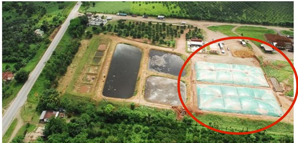
Ilustración 17: Laguna de estabilización Anaerobia
